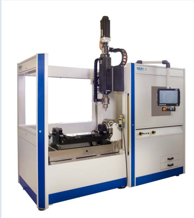
Abb. 1: Gesamtansicht universelle Montageeinrichtung für Ventilsitzringe, Ventileführungen und Zylinderlaufbuchsen
