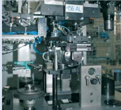
Abb. 7: Blockmaßmessen am Vorderachsgetriebe
