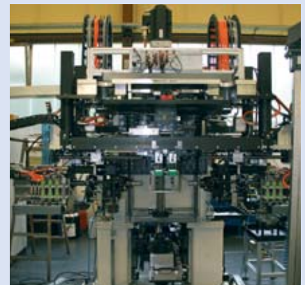
Abb. 10: Scheibenbestimmung S 2 /S 3 , VDS- und Gehäusebreitenmessung
