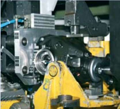
Abb. 6: Lagerreibmoment und Blockmaß- messen am Hinterachsgetriebe
