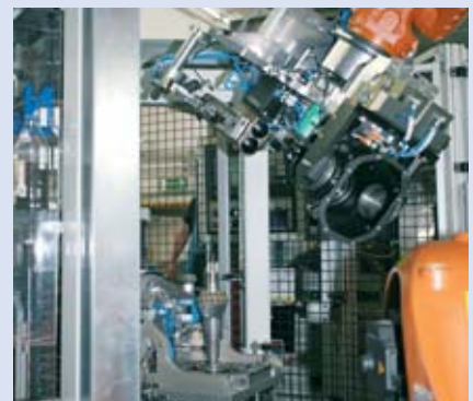
Abb. 3: Einlegen der Bauteile in die Anlage
