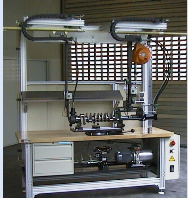
Abb. 1: Arbeitstisch für Kurbelwellenmontage
