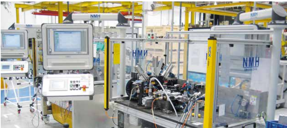
>> Messanlage zum Prüfen von Schaltauslegern im NKW Bereich
