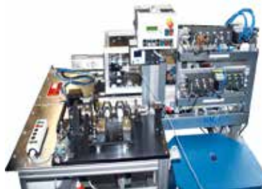
>> Station 2 (Rückseite): Drehmomentprüfung – Sitzfestigkeit Zahnrad auf Kurbelwelle
