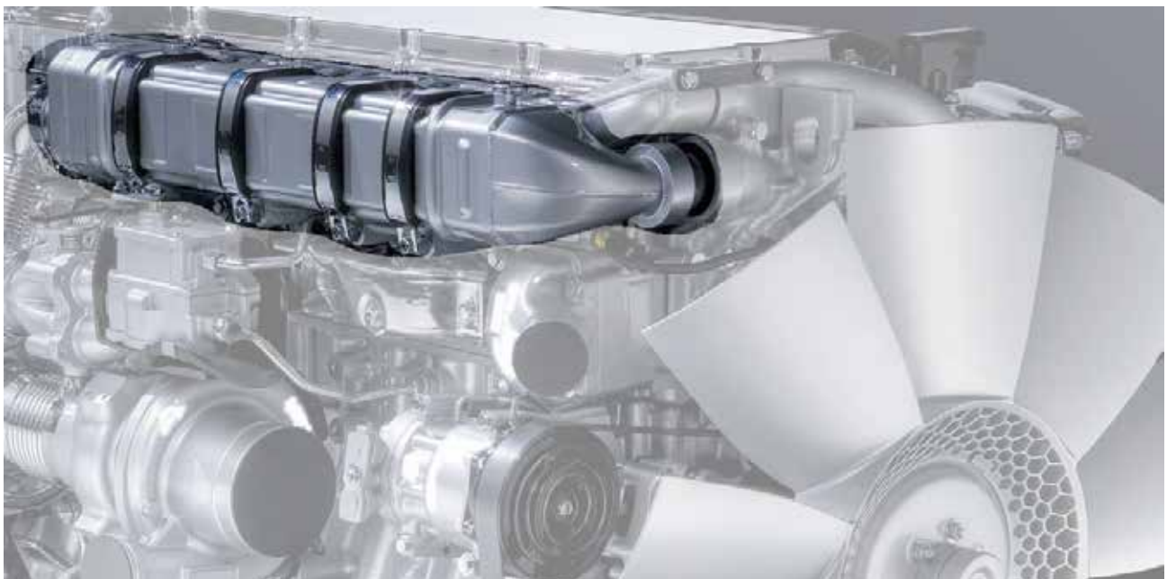
>> Darstellung: Verbauort Abgaswärmetauscher
