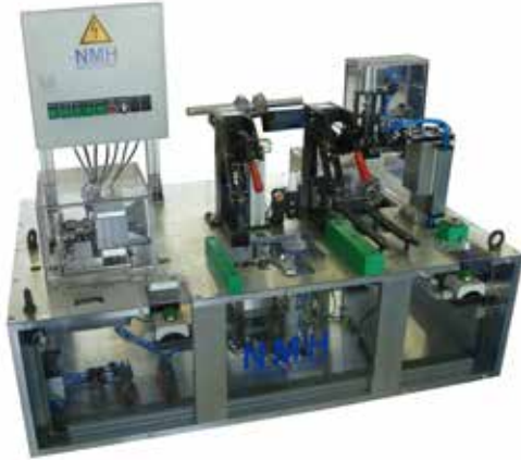
>> lehrende Dimensionskontrollvorrichtung für Abgaswärmetauscher
