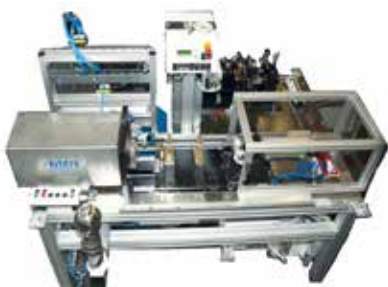
>> Station 1 (Vorderseite): Teilautomatisiertes Aufziehen von Zahnrädern auf Kurbelwellen
