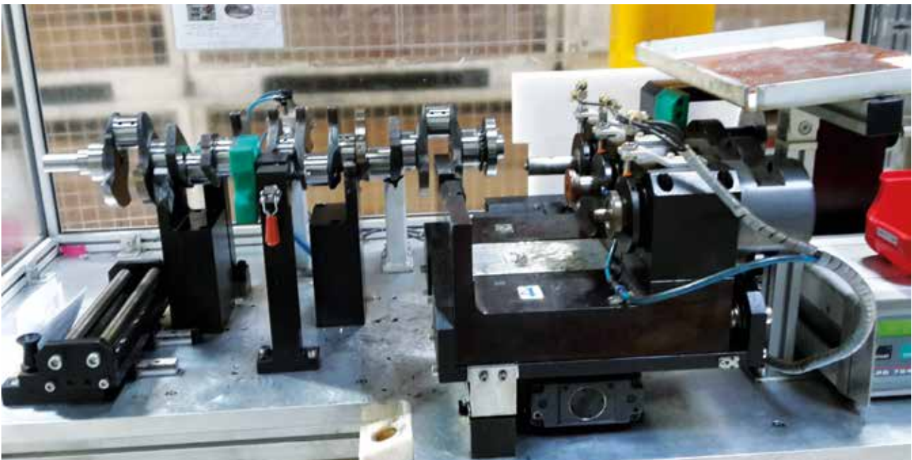
>> Einpressanlage und Dichtheitsprüfung Kurbelwelle kombiniert
