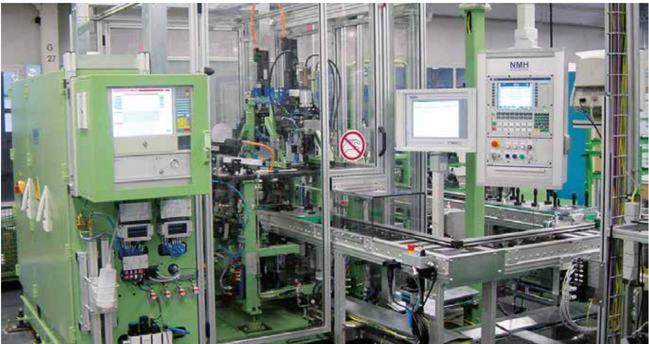
>> Übersicht: Prüfstand VAG auf Zahnspiel und Dichtheit
