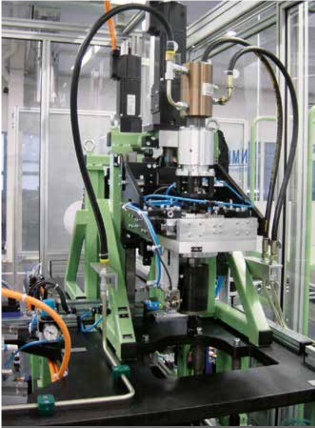
>> Zahnspielmessung VAG in Kombination mit Dichtheitsprüfung
