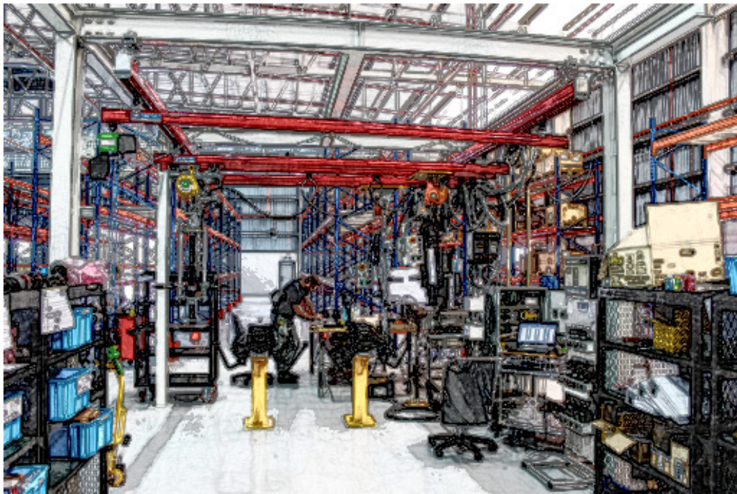
Montagelinie für Fahrwerksachsen. Hier: Hochflexible Vormontage von Radträgern (Cornermodulen)
