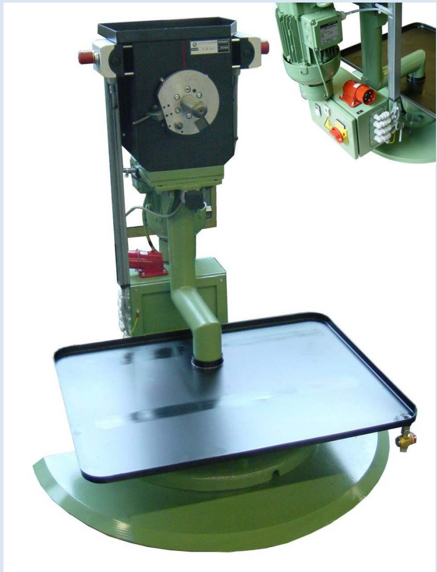
Abb. 1: Motorwender DRM 100-100 ohne Werkstück mit Ölauffangwanne Abb. 2: Rechte obere Ecke – Energieanschluss, Hauptschalter und Antrieb
